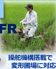
操舵機構搭載で変形圃場に対応
